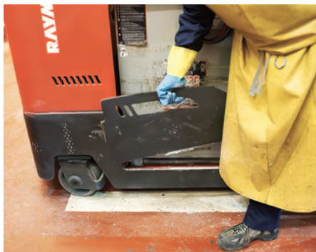
Dispositif de retenue de la batterie Photo : André Caty
