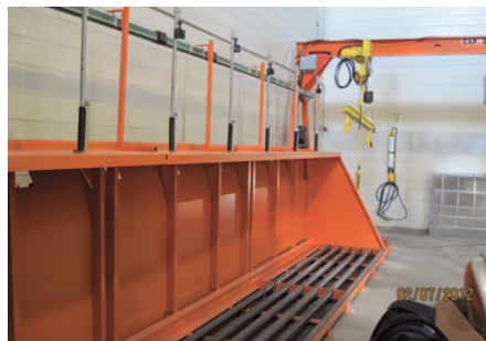
Pont roulant hydraulique pour extraction verticale (Courtoisie Liftow Ltée) Photo : André Caty
