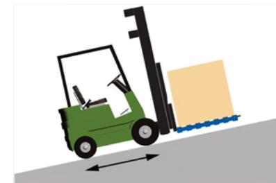
Monter et descendre avec charge
