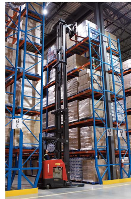
Chariot élévateur à fourche rétractable entre longerons, fourche en extension
